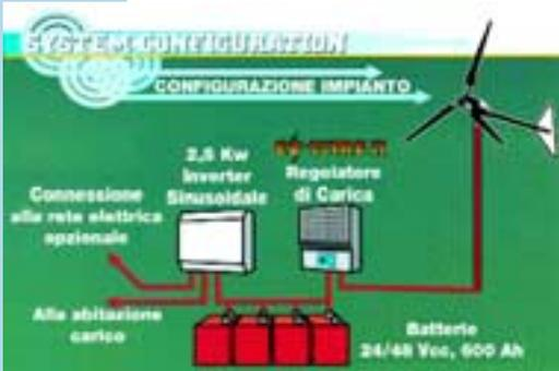
I Generatori Eolici a tre pale serie **H40** sono stati progettati per sfruttare al meglio venti con intensità medio-alta (circa 5,4 m/s - 19 Km/h di media o superiore anche in località non presidiate). Adatti per il fabbisogno energetico di baite, rifugi, case isolate dalla rete elettrica, telecomunicazioni, protezione catodica, telecontrollo, pompaggio dell'acqua
